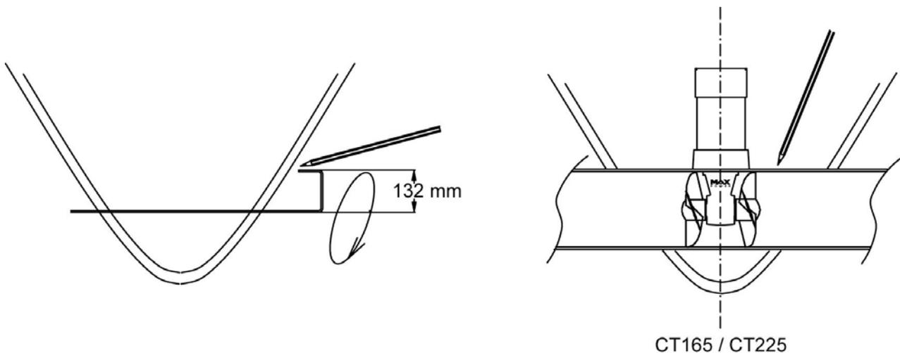
Replacer le tunnel. Stratifier (résine renforcée fibres de verre) en appliquant le mélange à l'intérieur et à l'extérieur sur toutes les zones, et en faisant bien attention de remplir tous les espaces entre la coque et le tunnel. Stratifier avec un minimum de 8 couches de tissus et de **RESINE ISOPHTALIQUE** alternées avec du mat et roving.
